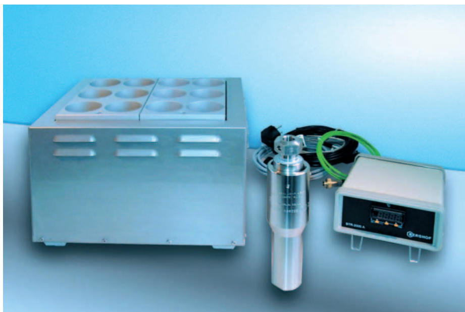
Abb. 1: Edelstahl Druckaufschlussystem mit 12-fach Heizblock und Temperaturregler
